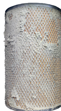
Filter vor der Reinigung
